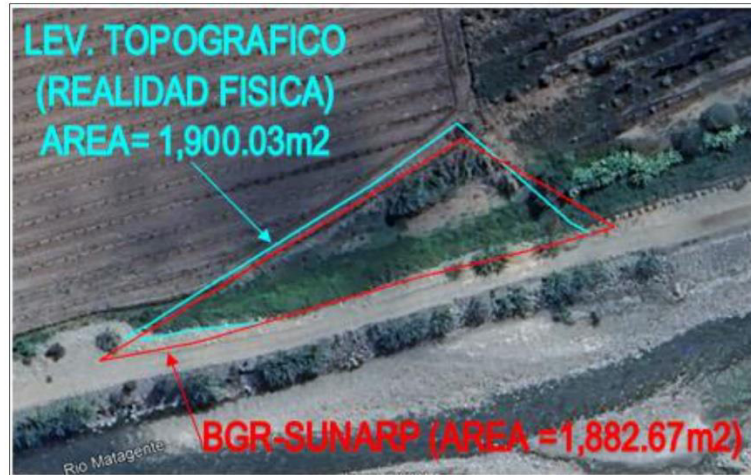
Imagen 05: Contraste de la base grafica registral y el levantamiento topográfico de la partida N°40006668
