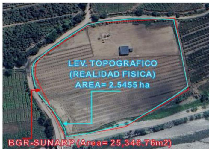
Imagen 05: Contraste de la base grafica registral y el levantamiento topográfico de la partida N°11003915
